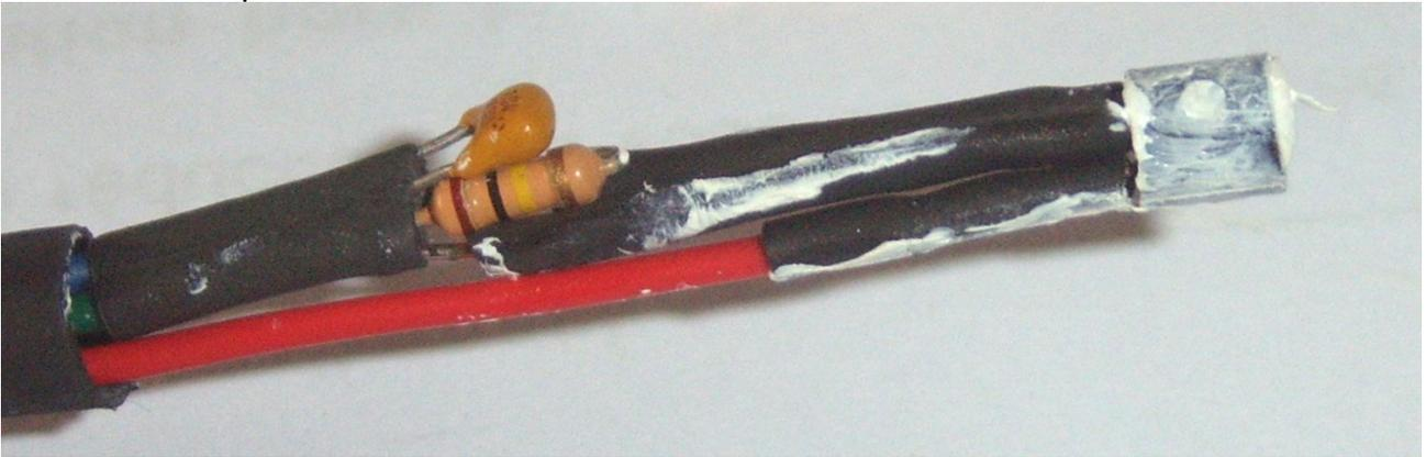
De la gaine thermo pour isoler, de la pâte thermique, un p'tit morceau de fil 1,5 mm pour caler le tout dans le tube, et encore une gaine pour finir,
