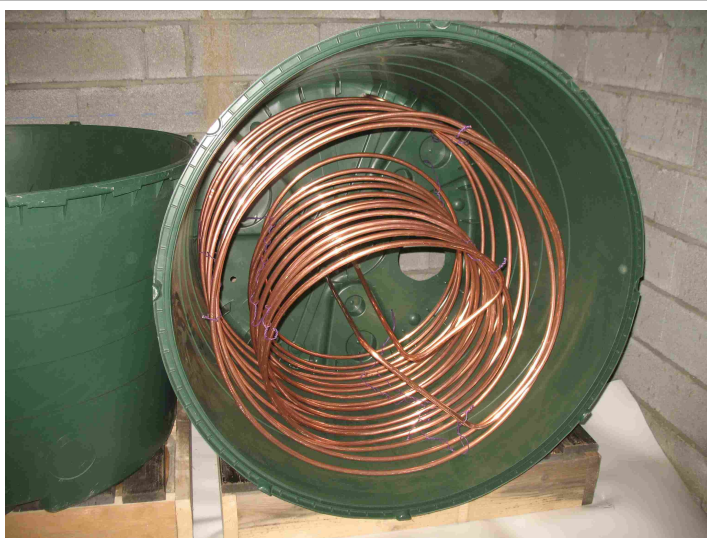
2 serpentins échangeurs de chaleur dans une citerne
