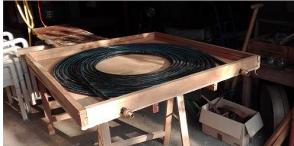
Avec un peu de plomberie et un radiateur et circulateur d'occasion, cette installation a tourné l'hiver dernier pour chauffer la cave (eau parfois à 20°) et en résultat une élévation de la température dans la cave de 3° dans la zone chauffée.
