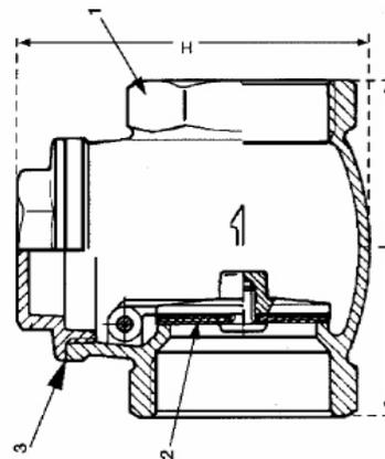
**Axe clapet à placer horizontalement, la meilleure position étant: axe horizontal sur canalisation verticale,**
